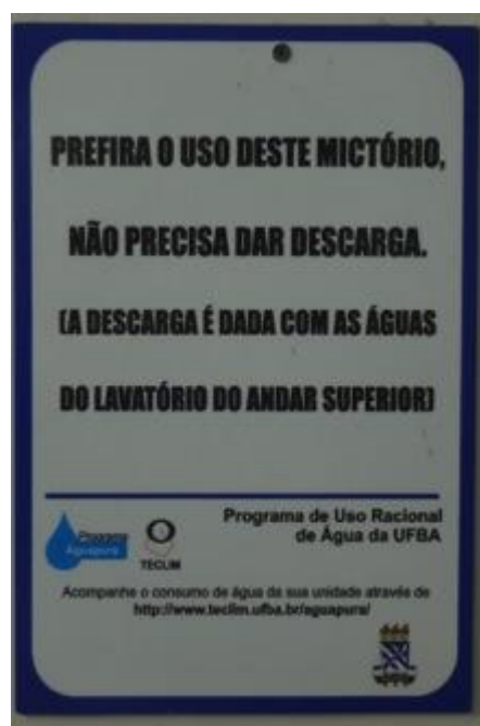
Figura 49. Detalhe do re-aproveitamento do efluente do lavatório (águas cinzas) na prumada nº 3, para descarga nos mictórios do andar inferior (5º e 6º andar) e cartaz informativo no mictório do sanitário masculino, 6º andar.
