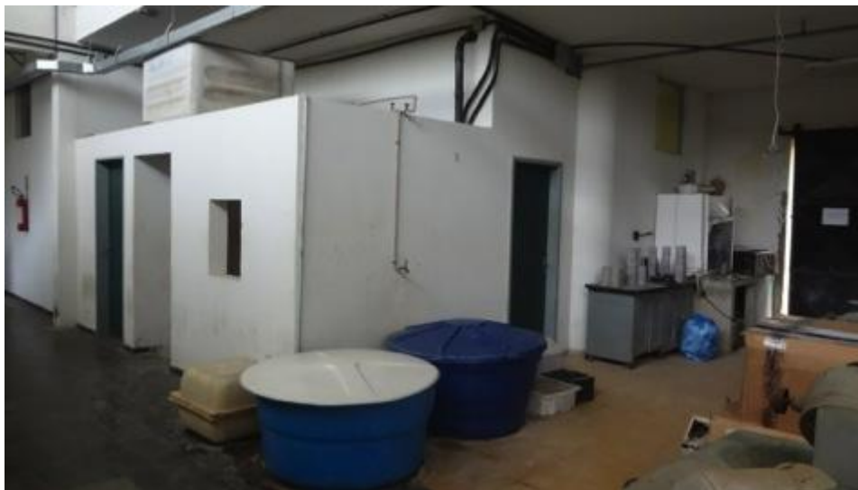
Figura 92. Tanques de cura de amostras em polietileno (500 l) e caixa d'água de 1000 l em fibrocimento, no alto.
