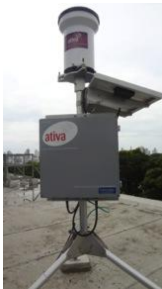
Figura 27. Plataforma de Coleta de Dados Pluviométricos, instalada na cobertura do prédio principal da EP-UFBA pelo Cemaden – Centro Nacional de Monitoramento e Alertas de Desastres Naturais.
