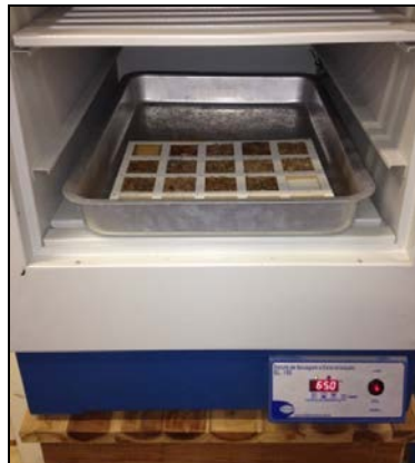
Figura 25 – Etapa de cura dos corpos de prova com látex modificado e não modificado e serragem, com cura a temperatura a 65 °C.
