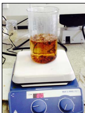
Figura 17 – Imersão da serragem eucalipto na solução.
