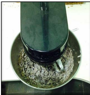
Figura 23 - Mistura da serragem de eucalipto e látex
