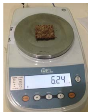
Figura 28 – Corpos de prova tendo sua massa medida
