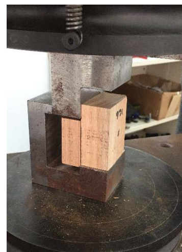
c) Detalhe do corpo de prova rompido, após o ensaio.
