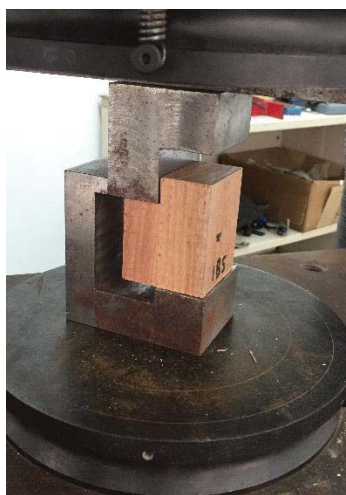
b) Detalhe do corpo prova posicionado, antes do ensaio.
