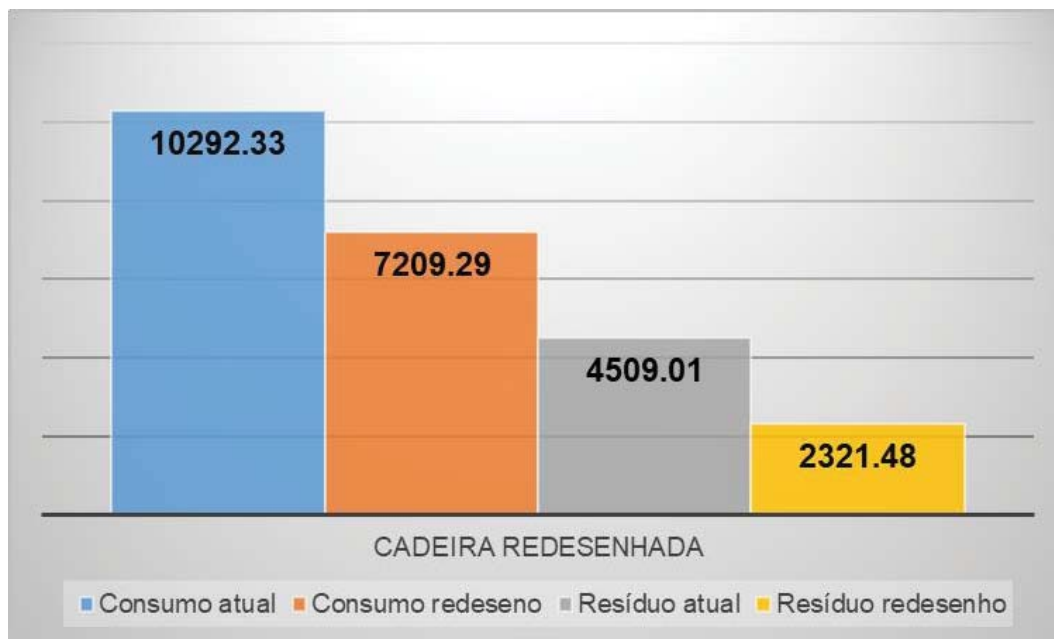
Figura 20 – Comparativo do processo de produção da empresa x proposta, para o consumo de madeira e os resíduos gerados (g).
